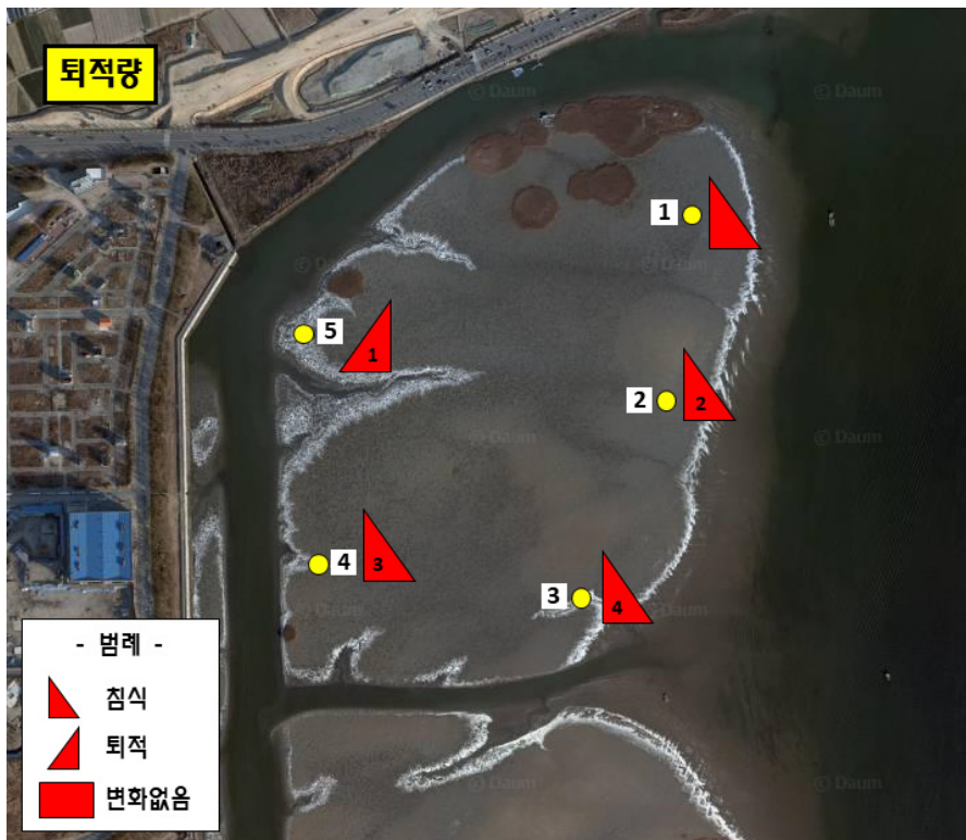
〈그림 4-62〉 명지 지역의 조사 정점 및 퇴적량 변화(침식 및 퇴적 표시내 숫자: 퇴적 및 침식된 높이(단위:cm))
