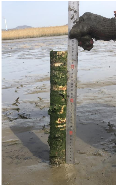
〈그림 4-58〉 퇴적량을 측정하기 위하여 을숙도 정점 2에 설치된 말뚝의 모습 (빨강색 표기: 10cm; 노란색 및 검정색: 1cm)
